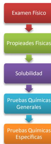
Figura 1. Esquema de pasos para la elucidación de un compuesto químico presente en una incógnita.
